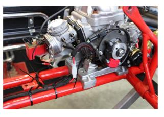
Verlegung und Anschluss vom Kabelbaum am Motor
